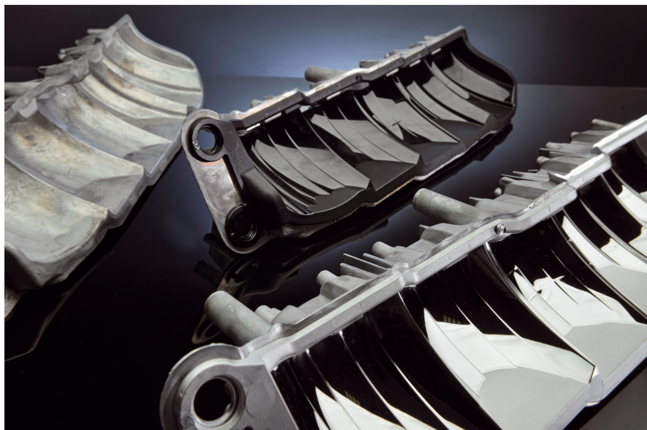
Drei Stufen der Herstellung eines Scheinwerferreflektors. Von links nach rechts: druckgegossener Reflektorträger, hinterspritzter Hybrid-Reflektor, Reflektor nach PVD-Beschichtung. © IKV, Hella, Fraunhofer ILT
